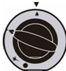
rys 10. Położenie pokrętła na płomień minimalny
