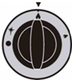
rys 9. Położenie pokrętła na płomień maksymalny
