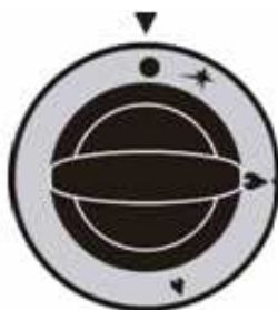
rys 11. Położenie pokrętła w pozycji „kurek gazowy zamknięty”
