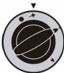
rys 8. Położenie pokrętła podczas zapalania palnika pilotującego
